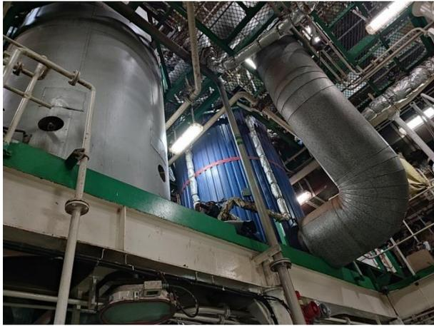
机舱顶部及排气管路
